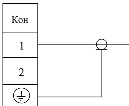
Рисунок 14 Схема подключения кабеля РК-50 к пьезодатчику ПЭП 3-4
