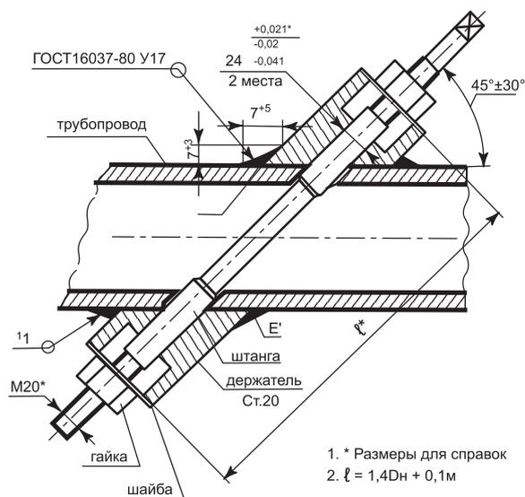
Штанга изготавливается из углеродистой стали и должна быть ровной и отшлифованной. Возможно изготовление штанги на предприятии-изготовителе по заказу. Производить работы с изогнутой штангой не допускается. Длина штанги зависит от диаметра трубопровода и угла врезки датчиков. Конкретная ее длина выбирается из таблицы 2.
